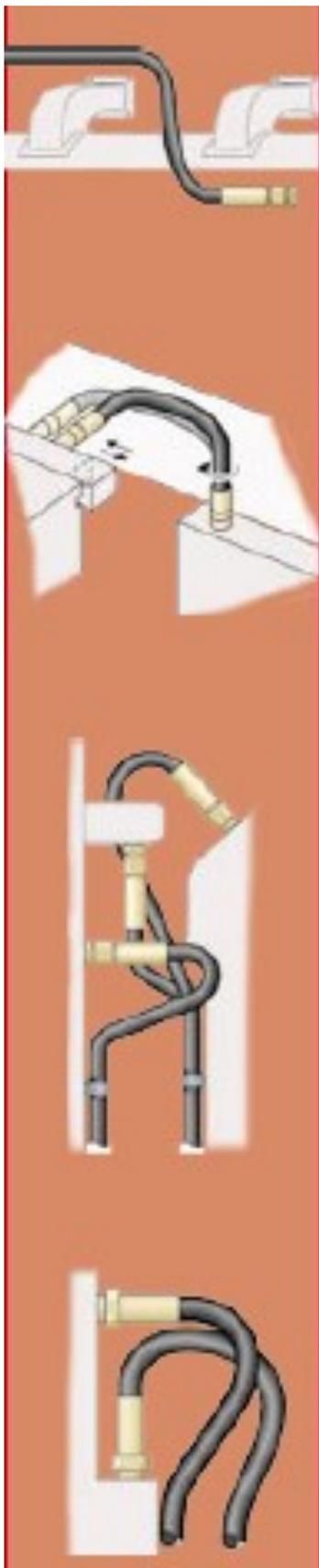
Das korrekte Befestigen des Schlauches (für Halt/ Unterstützung) sollte beachtet werden, damit der Schlauch sicher verlegt bzw. vermieden wird, dass der Schlauch mit Oberflächen in Berührung kommt, die zu seiner Beschädigung führen. Es ist jedoch sehr wichtig, dass der Schlauch seine Funktionsfähigkeit als „flexible Leitung“ behält und dass Längenänderungen möglich sind, wenn er unter Druck steht.
