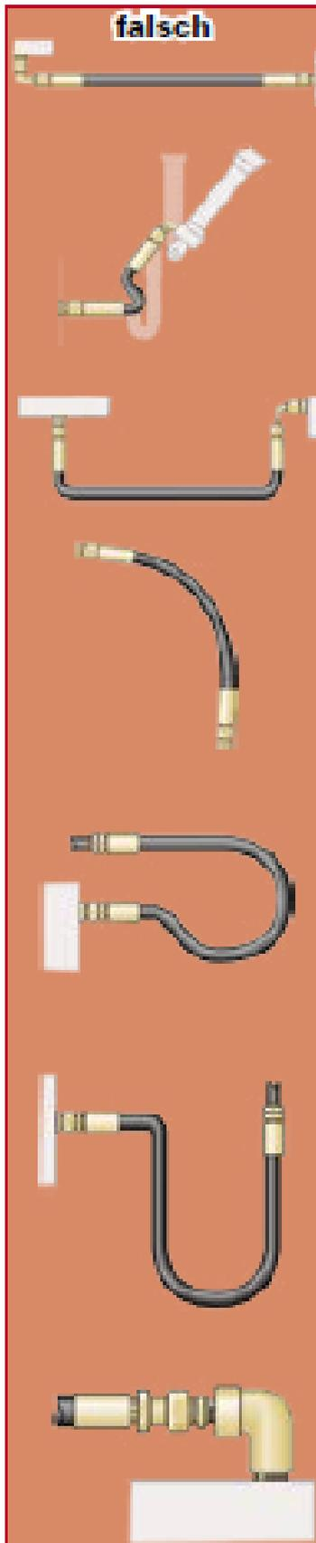
Das Verlegen der Schlauchleitung und die Umgebung, in der sie betrieben wird, beeinflussen unmittelbar die Lebensdauer einer Schlauchleitung. Die folgenden Diagramme zeigen die sachgemäße Verlegung von Schlauchleitungen, die deren Lebensdauer maximieren und eine sichere Funktionsfähigkeit gewährleisten.
